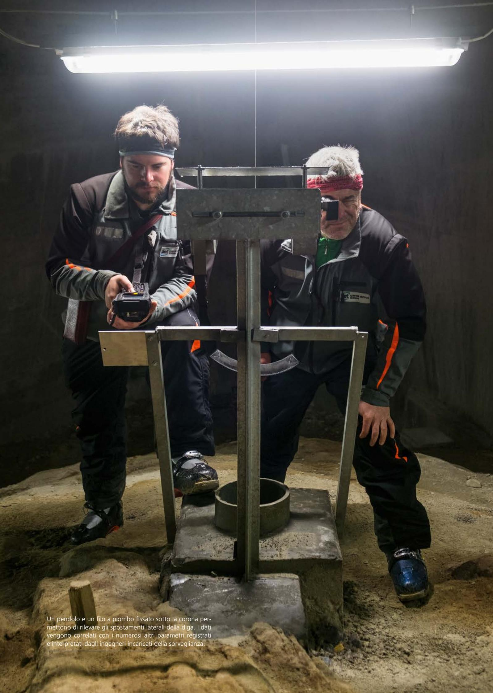
Un pendolo e un filo a piombo fissato sotto la corona permettono di rilevare gli spostamenti laterali della diga. I dati vengono correlati con i numerosi altri parametri registrati e interpretati dagli ingegneri incaricati della sorveglianza.
